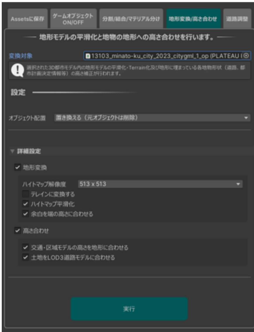
図3-1-29 地形変換／高さ合わせ画面
