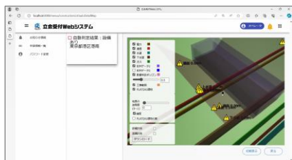
立ち合いシステム ※計画している地下構造物と既設の埋設物の 離間距離を確認できる
