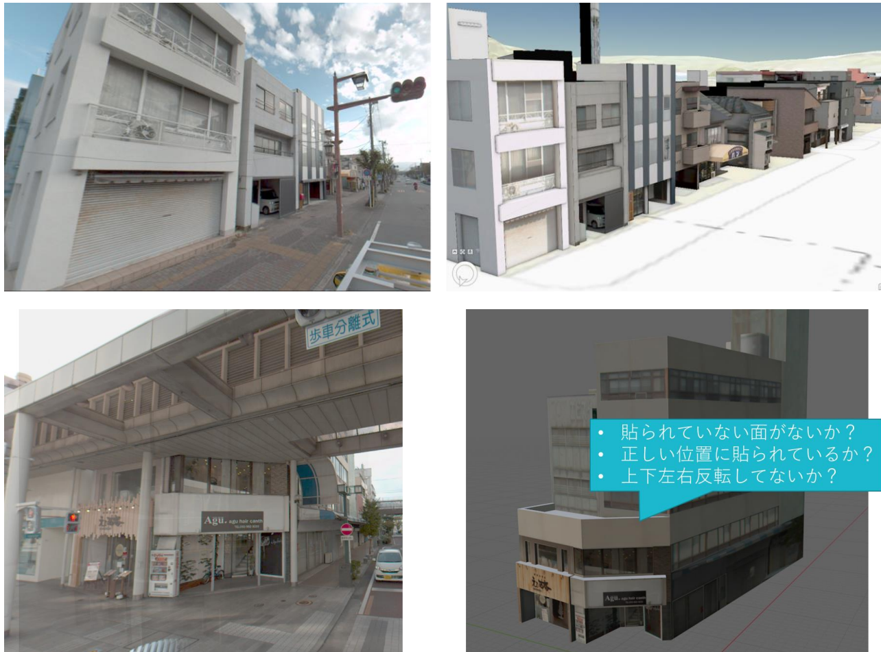
図 9-1 完全性の品質評価（MMS 全方位画像との照合例）
