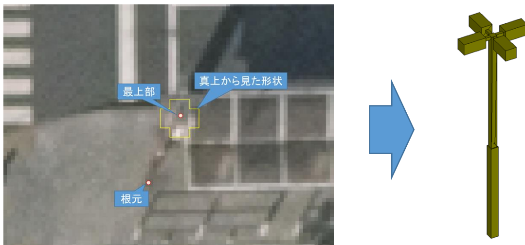
図 6-10 空中写真での図化イメージと出来上がりのモデル
