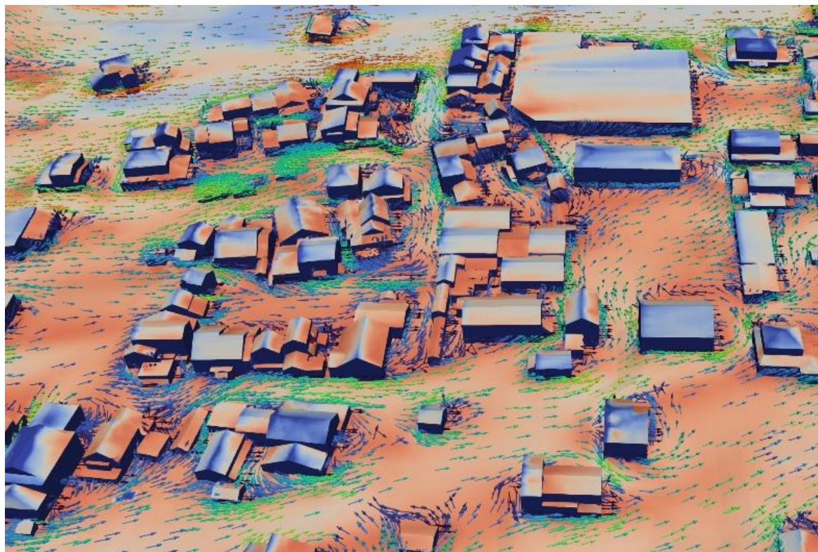
図 気流解析と積雪計算の結果 地形に応じた風速分布と積雪の偏在を計算
