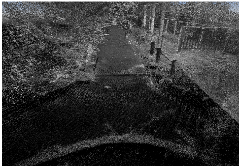
図1 点群データからの歩車道区分表示イメージ （粕森公園内歩道）
