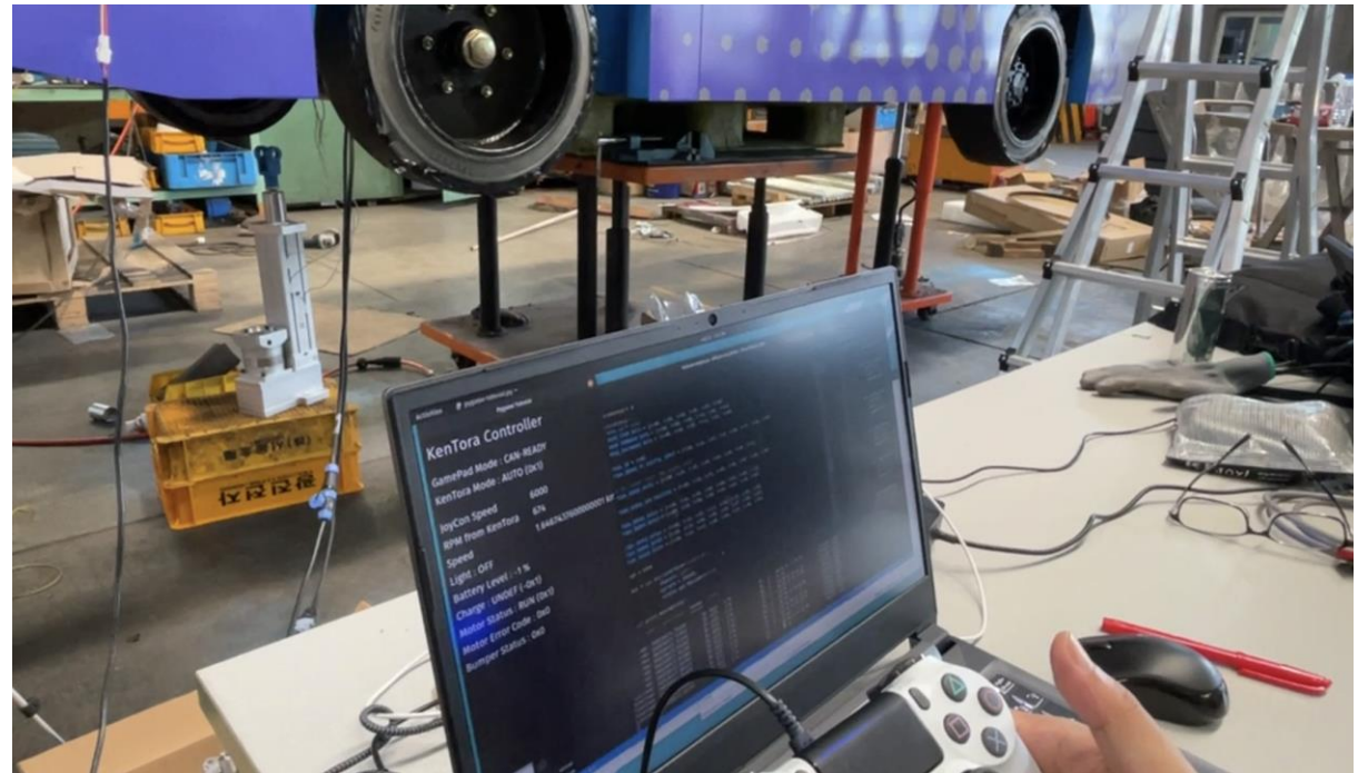
ゲームコントローラーでCANBUS信号を確認している様子
