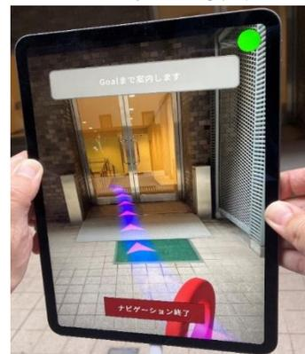
ARデバイスの映像とVPS用点群データを突き合わせ現在位置を推定
