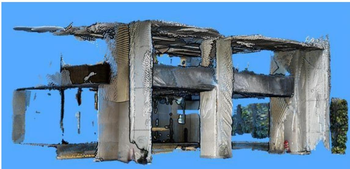
(左) バス搭載センサーのLASファイルを複数組み合わせて作成した点群に、iPhone LiDARでスキャンしたデータを追加し、死角をカバーしたもの
