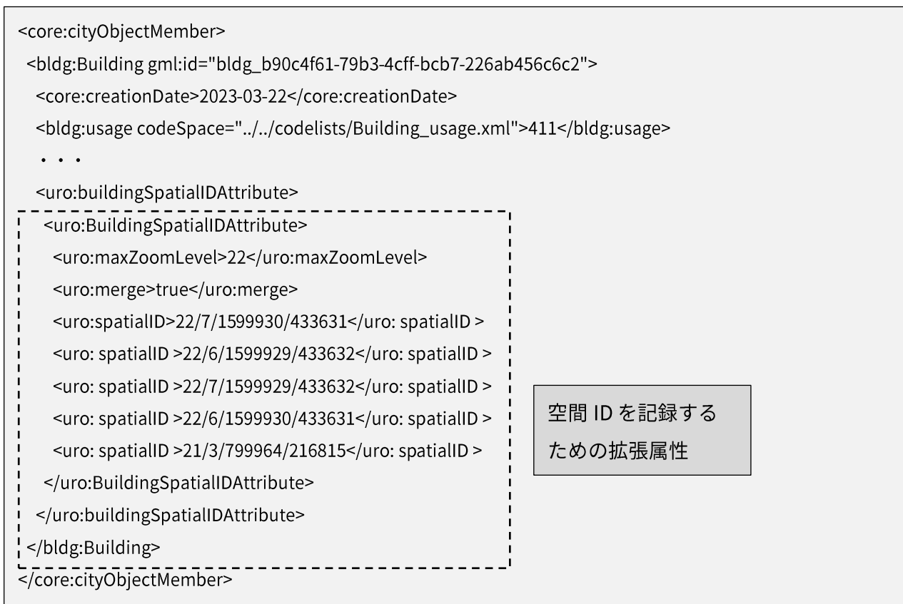
図 4-3 空間 ID を CityGML ファイルへ直接付与した例
