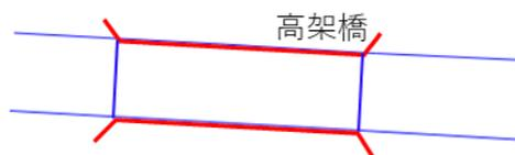
図 3-39 道路構造変化点による分離
