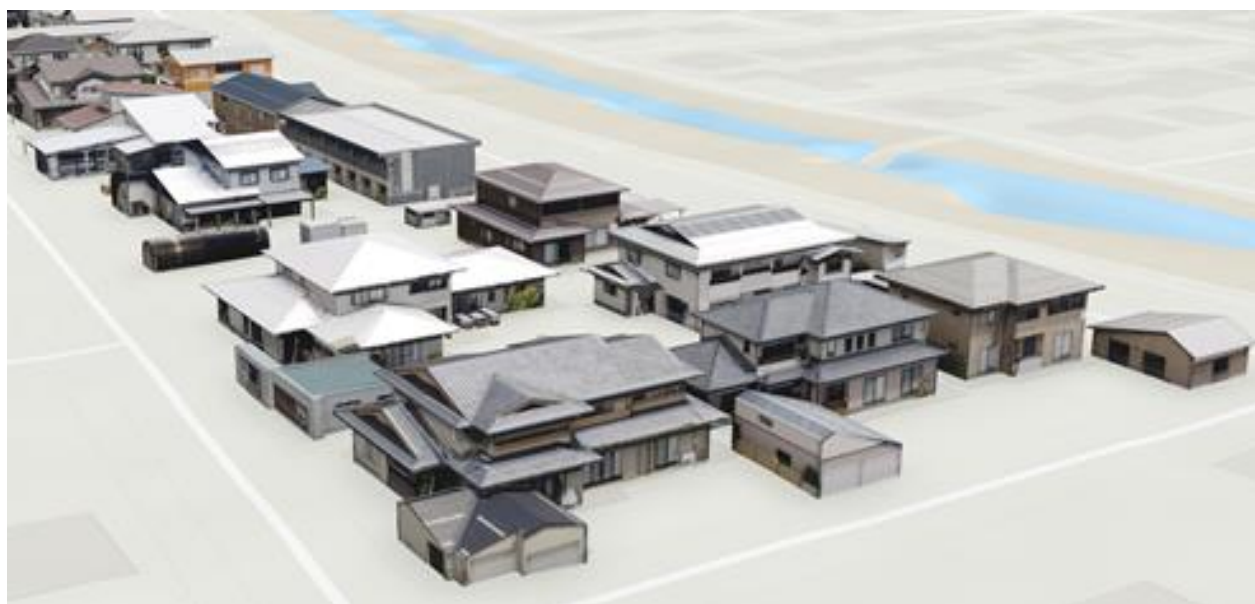
図 3-9 多方向カメラ撮影成果から作成した建築物モデル LOD3 の試作事例
