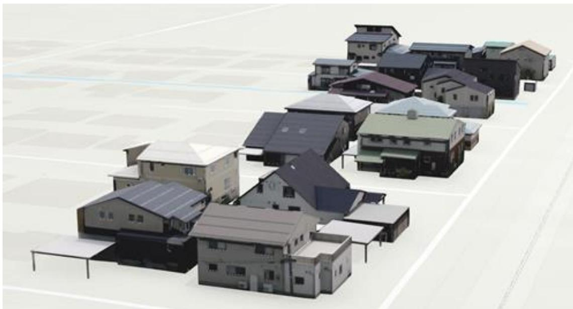
■多方向カメラ撮影成果から作成した建築物モデル LOD3 の試作事例 2
