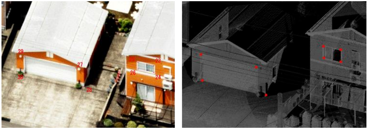
図 3-8 多方向カメラ（左図）と車載写真レーザ測量（右図）の成果の較差検証事例
