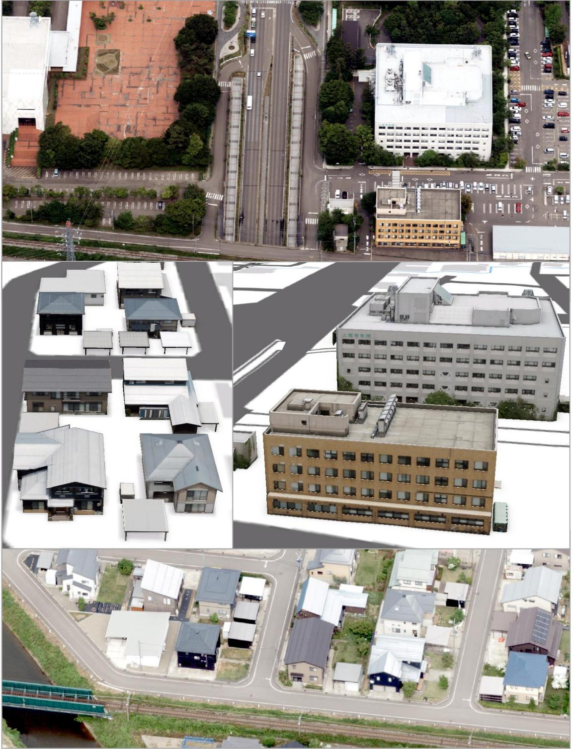
多方向カメラを用いた空中写真測量による
