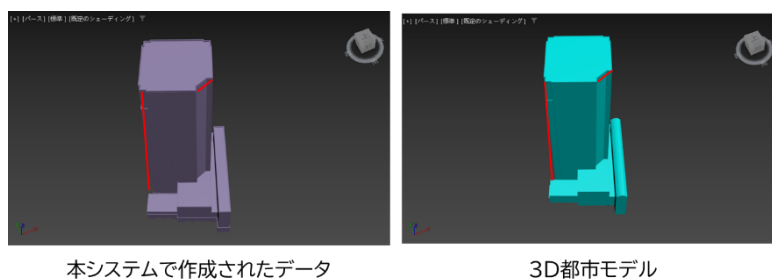
図 5-15 相対位置正確度の検証箇所の例（建築物モデル）（赤線部の距離をそれぞれ計測）
