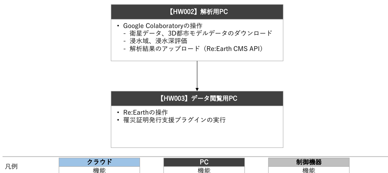
図 3-6 ハードウェアアーキテクチャ（衛星画像解析、罹災証明書発行支援ツール）
