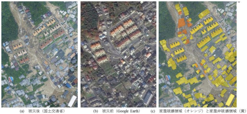
図 4-3 正解データ (家屋の倒壊/非倒壊判定) の根拠<sup>10</sup>
