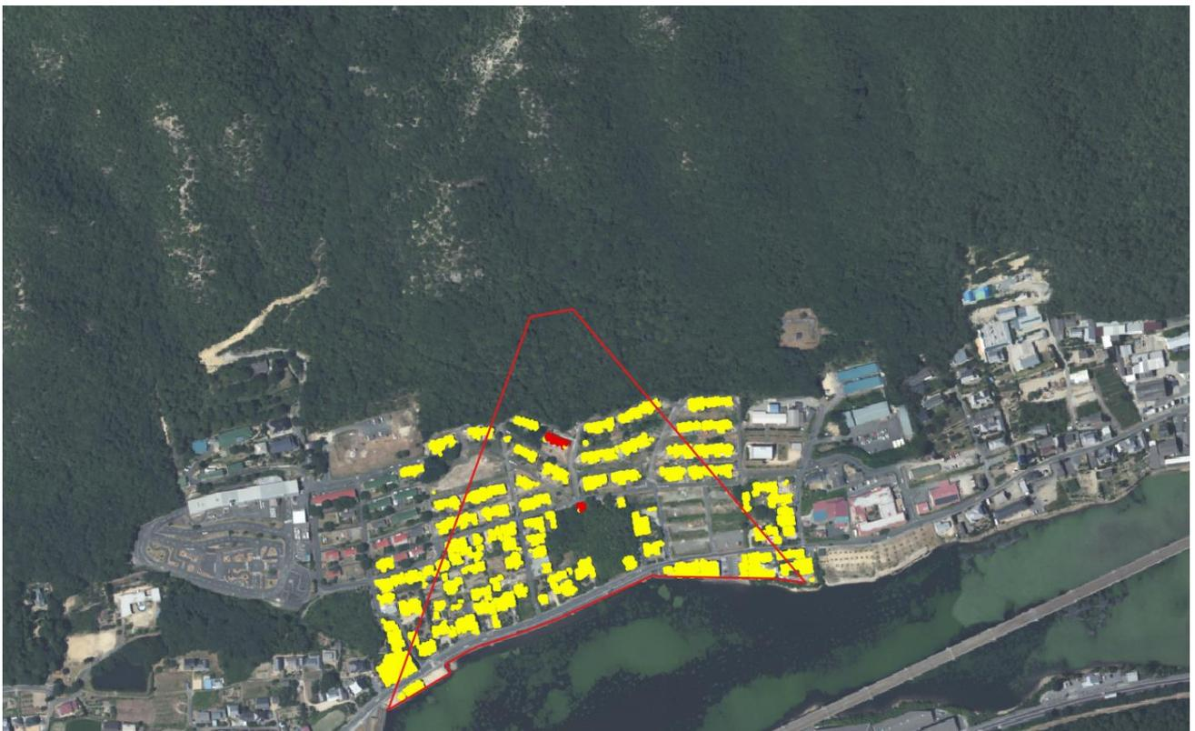
図 5-12 建物倒壊判定 (Building) の QGIS による可視化
