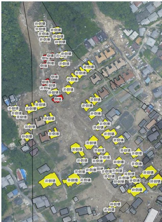
図 4-5 判定結果（家屋の倒壊/非倒壊判定）
