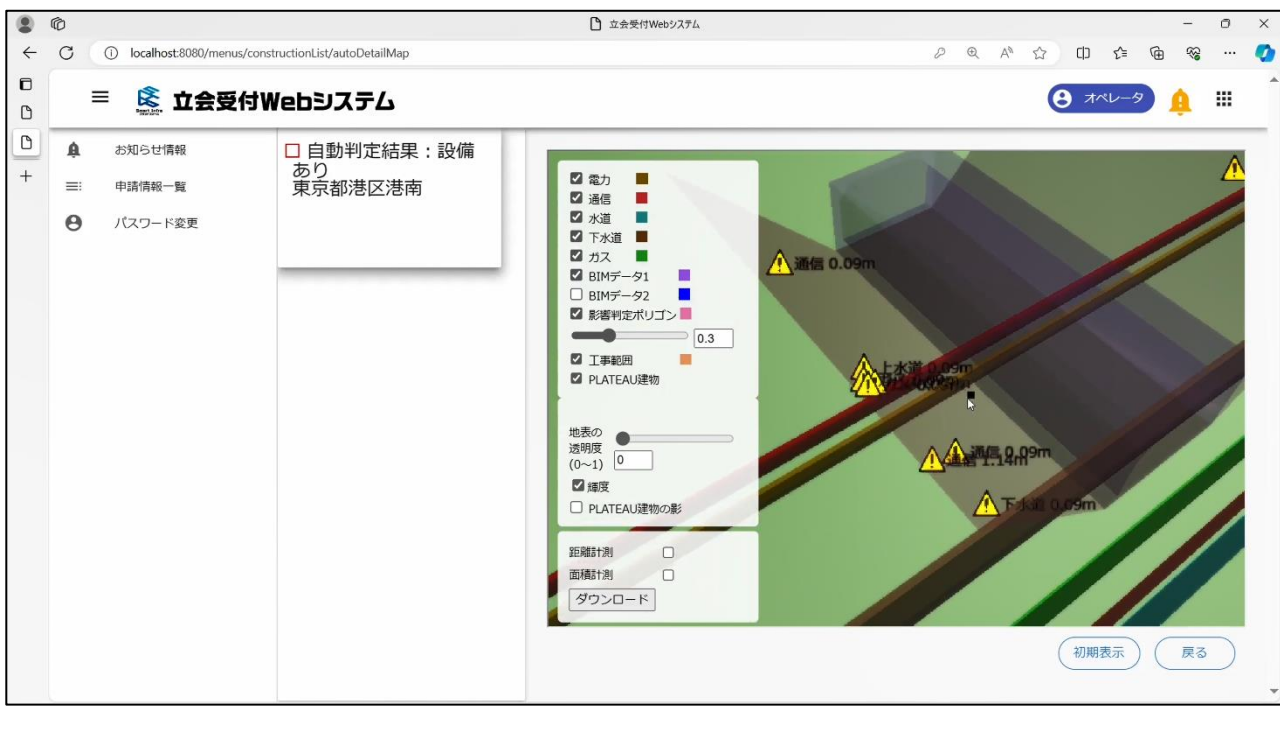
⑥-3：計画する地下構造物と既設の地下埋設物の離隔距離を確認
