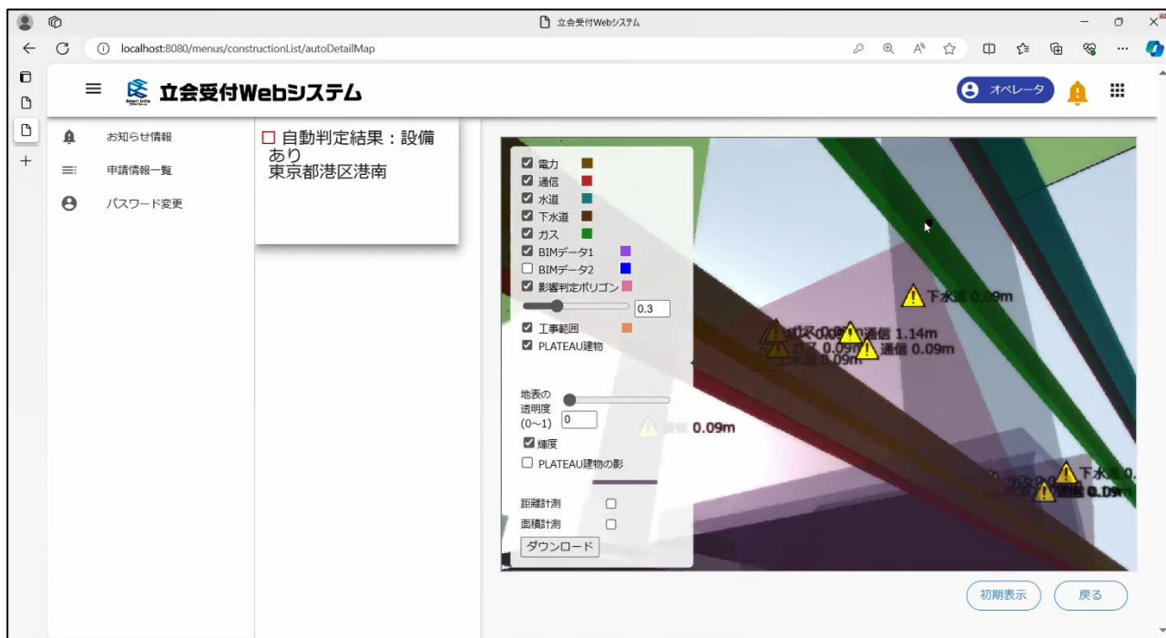
⑥-3：計画する地下構造物と既設の地下埋設物の離隔距離を確認
