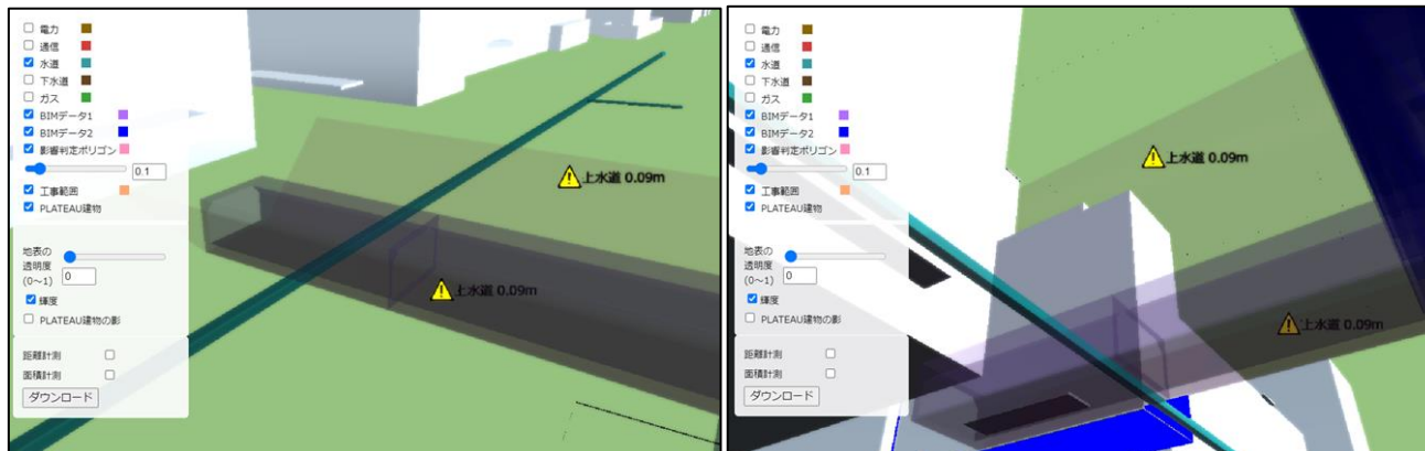
図 3-37 地下埋設物モデル（水道）
