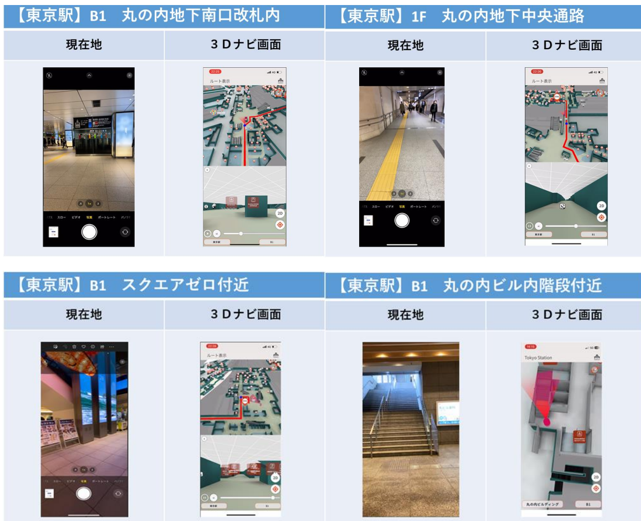
図 4-2 屋内測位による自位置表示の目視確認（東京駅エリア）（2/2）
