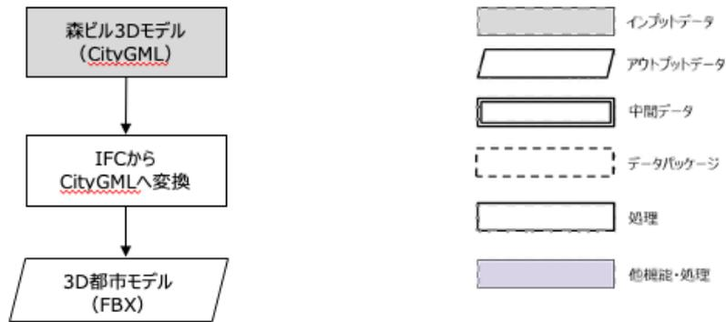
図 3-33 【FN023】 CityGML to FBX 変換機能
