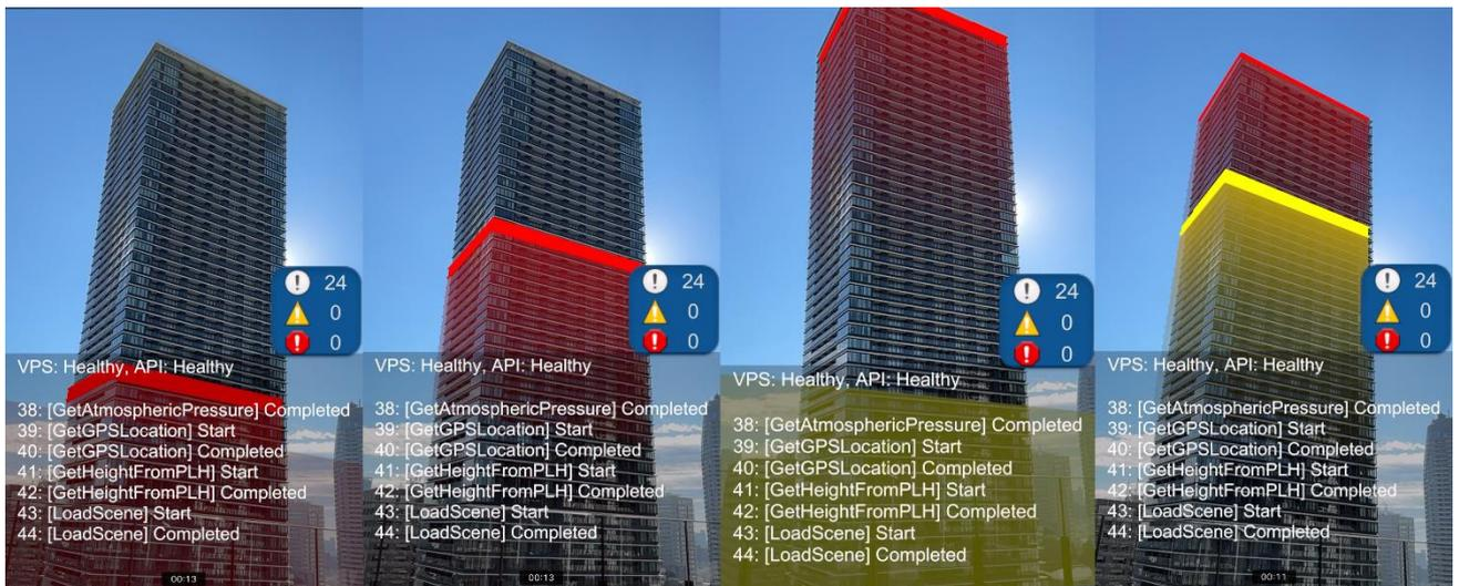
図 4-18 屋外での 3D 都市モデル (LOD3) によるオクルージョンマスク検証
