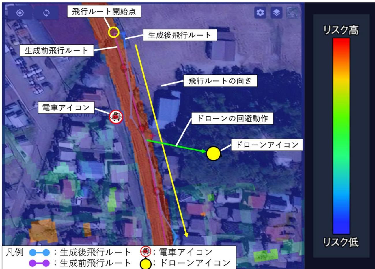
図 4-15 エリア密集度（高）ドローンの進行方向（同一）鉄道（60km/時）の検証
