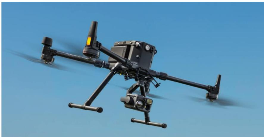
図 3-7 DJI Matrice 300. RTK<sup>1</sup>
