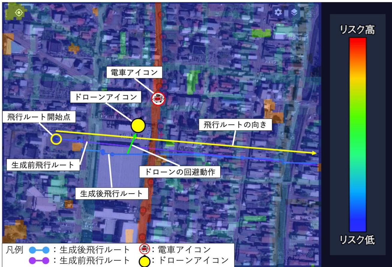
図 4-19 エリア密集度（高）ドローンの進行方向（90度）鉄道線の速度（20km/時）の検証
