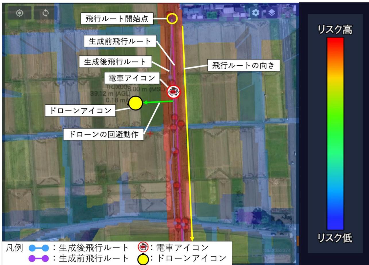
図 4-9 エリア密集度（低）ドローンの位置（線路上を飛行）の検証
