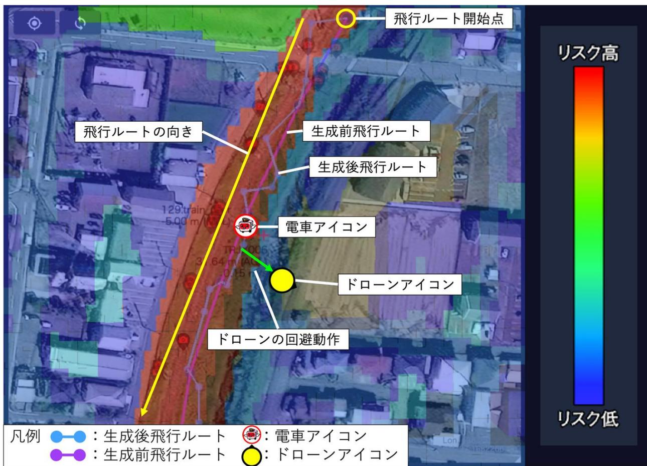
図 4-31 エリア密集度（中）ドローンの進行方向（同一）鉄道（20km/時）の検証
