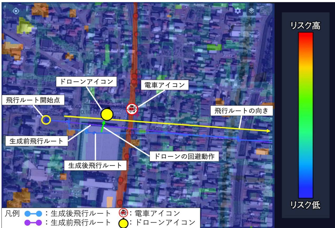
図 4-23 エリア密集度（高）ドローンの進行方向（90度）鉄道線の速度（90km/時）の検証
