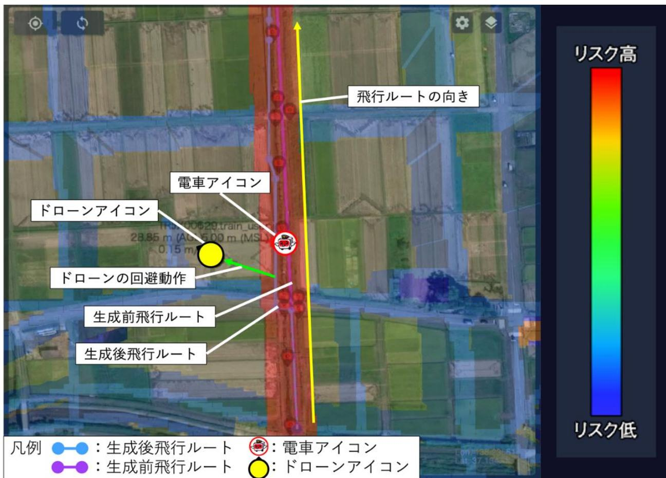
図 4-65 エリア密集度（低）ドローンの進行方向（180度）鉄道線の速度（90km/時）の検証
