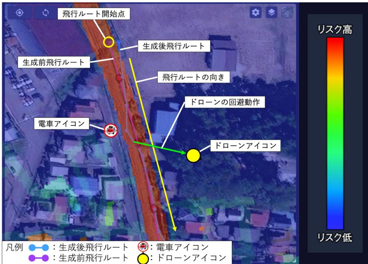
図 4-17 エリア密集度（高）ドローンの進行方向（同一）鉄道（90km/時）の検証
