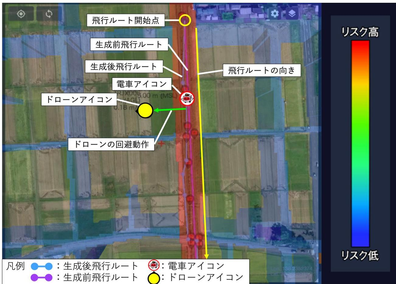
図 4-49 エリア密集度（低）ドローンの進行方向（同一）鉄道線の速度（20km/時）の検証
