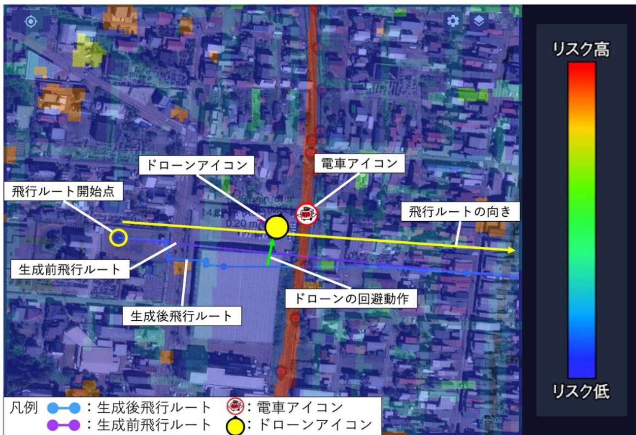
図 4-21 エリア密集度（高）ドローンの進行方向（90度）鉄道線の速度（60km/時）の検証
