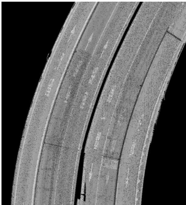
図 4-20 床板に分類された 3D 点群データ
