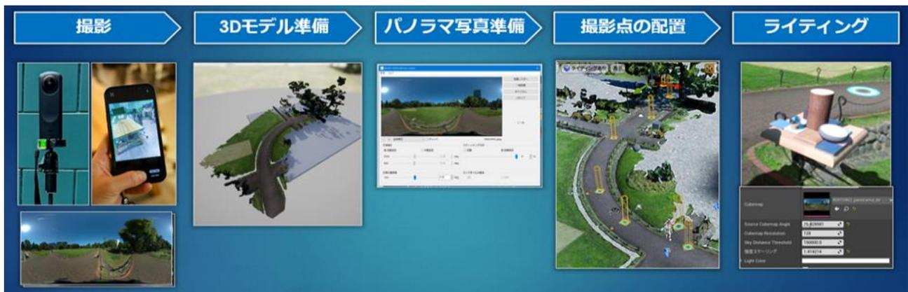
図 3-8 全天球写真ベースの景観散策システムのフロー図
