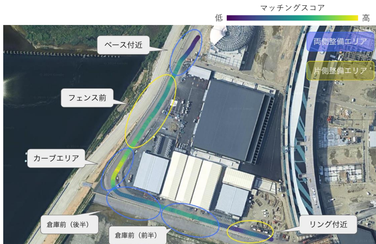
図 7-17 マッチングスコアヒートマップ（PCLG マップ+RTK 補正あり）
