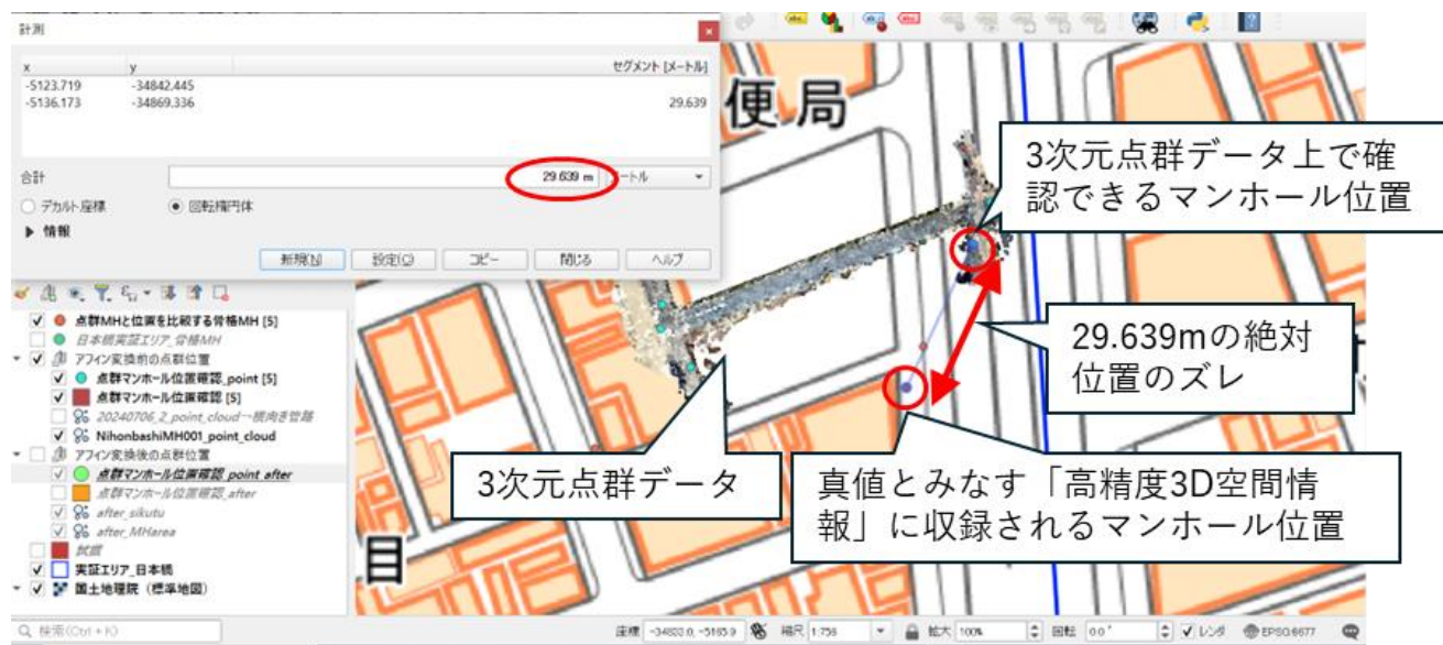
図 7-2 3次元点群データと「高精度 3D 空間情報」のズレの確認
