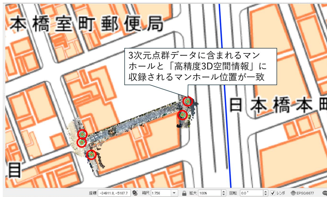
図 7-3 3次元点群データの絶対位置を補正した結果
