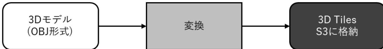
図 4-14 3D Tiles への変換
