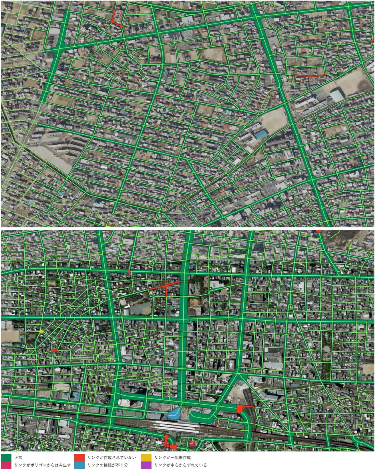
図 3-9 岐阜県岐阜市車道ネットワーク (LOD1) リンク作成例
