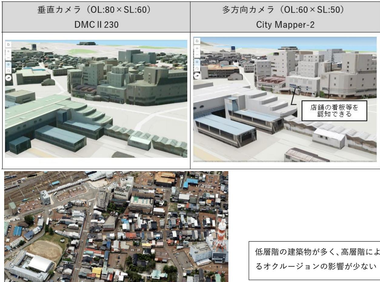
図 1-3 新潟県上越市の垂直カメラと多方向カメラのテクスチャ比較事例
