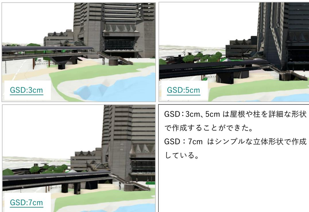
図 3-20 橋梁モデル LOD3 の作成事例
