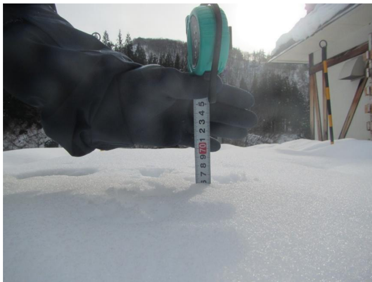
図 7-4 積雪断面観測イメージ (積雪深の観測)
