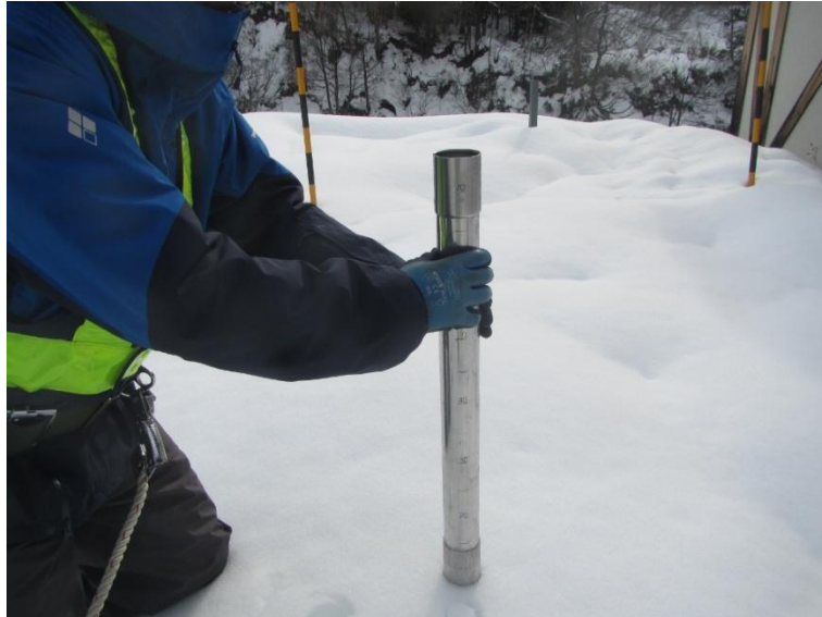
図 7-3 積雪断面観測イメージ (スノーサンプラーによる雪の採取)
