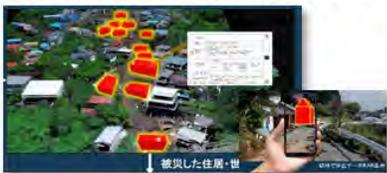
住居情報と流出土砂の三次元解析による被害状況把握システム
