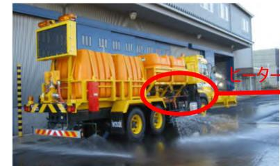
ヒーターを設置し、塩化ナトリウム水溶液を加熱することにより、温塩水を生成
