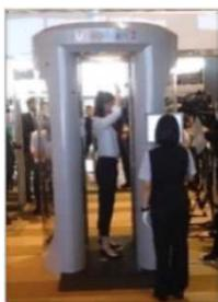
現行の接触検査に代わるものとして、自動的に非接触で人体表面の異物を検知する装置
