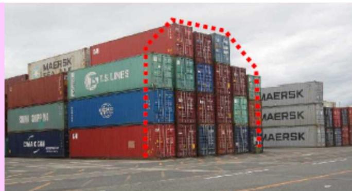
風に強いコンテナの積み方
