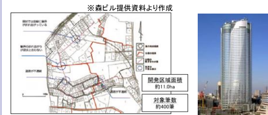
【従前の公図】6枚の公図をつなぎ合わせたものの、図の境界で不連続が発生
