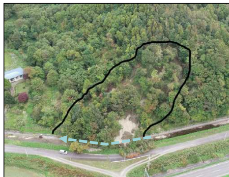
【新鷲川地区】川西幹線用水路 流入した土砂による開水路の閉塞
