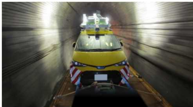
3次元点群データ計測車両 (伊豆急行線トンネル内)
