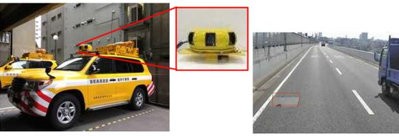
巡回点検車両      路面損傷の検知
