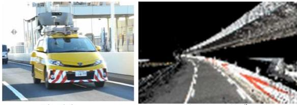
計測車両      3次元点群データ
