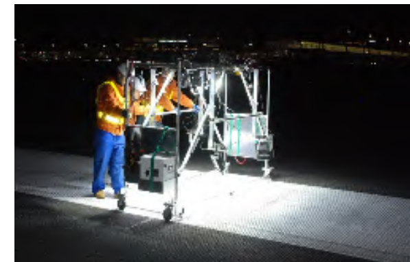
高解像度画像からのクラック自動抽出技術による空港の舗装巡回点検用モニタリングシステムの研究開発
