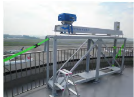
地上設置型合成開口レーダおよびアレイ型イメージングレーダを用いたモニタリング
