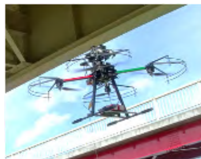
▲橋梁の損傷写真を撮影する技術
