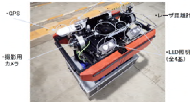
寸法: L1210 × W800 × H925(突起部を除く) 重量: 約100kg
