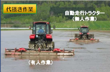
有人トラクターと無人トラクターの協調作業で作業効率が大幅に向上
