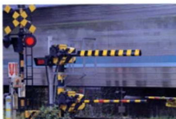
大型遮断機 十二段型遮断装置
