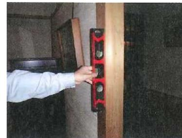
水平器による柱の傾きの計測
