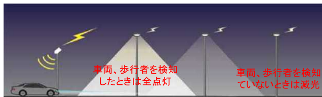
照明とセンシング技術を融合し車両検知時のみ点灯する照明
