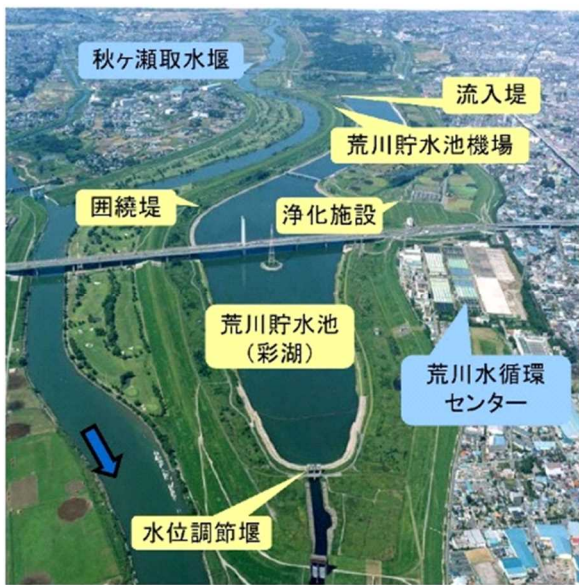
図 36 秋ヶ瀬取水堰下流への放流量（上図）と荒川調節池総合開発施設の概要（下図）
