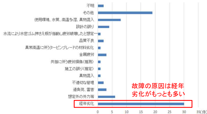
故障原因(河川機械設備)
