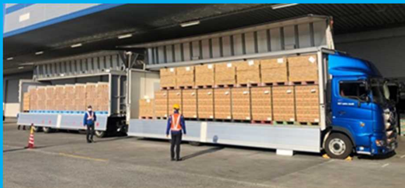
混載による荷室の使い切り。積載率70%
