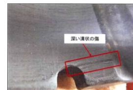
ポンプ軸受内径側に溝状傷
