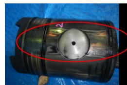
ピストン損傷
