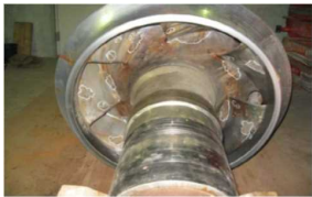
ポンプ羽根車の壊食状況
