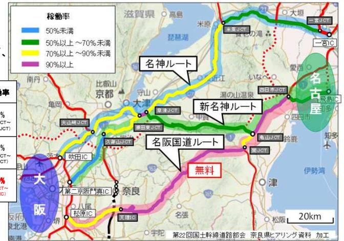
$$\text{稼働率} = \frac{\sum (\text{交通量} \times \text{区間延長})}{\sum (\text{交通容量} \times \text{区間延長})}$$
