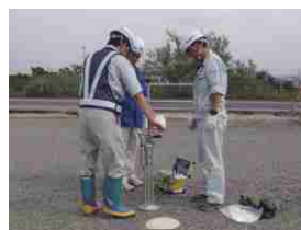
衝撃加速度による盛土の品質管理方法
