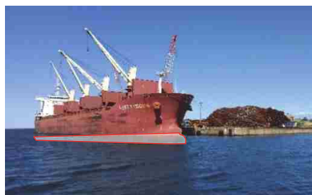
約30000DWT船 →現状は水深の制約により満載で入港できない
