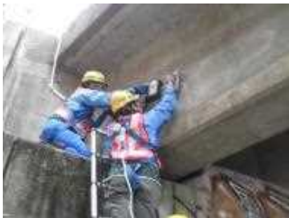
磁気の磁束密度を測定し内部の損傷を把握
