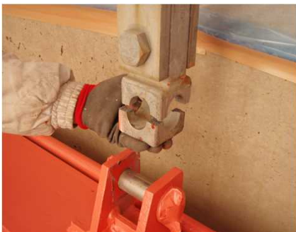
ラック式開閉装置 ラック棒 吊金具の破断
