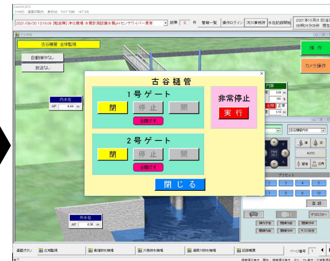
樋管操作画面（運転操作画面）
