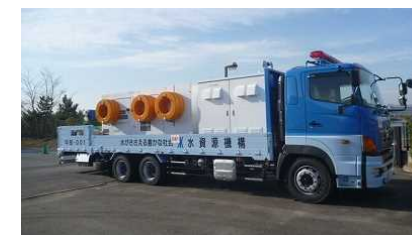
左: 資材の備蓄状況(鋼管、継手補強材、ブルーシート等) 右: 災害用応急ポンプ車
