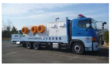
上: 資材の備蓄状況(鋼管、継手補強材、ブルーシート等) 下: 災害用応急ポンプ車 出典:(独)水資源機構
